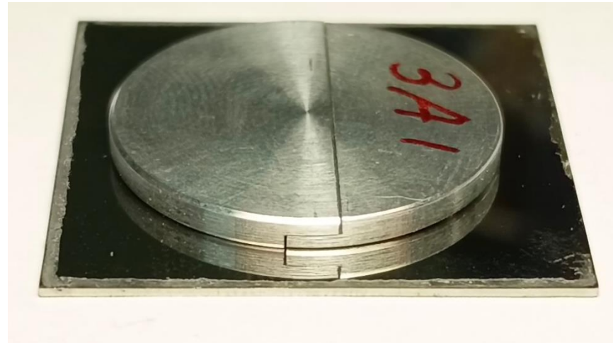
Фотографии экспериментальных сборок с дисками из Д16Т
